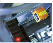
Le capteur efector *pmd* fournit un signal analogique (4...20 mA) proportionnel à la distance de l'objet à détecter. La sortie analogique est réglable.
