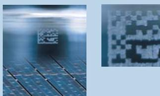
Les codes gravés au laser sur des panneaux photovoltaïques thermiques et du verre peuvent être difficiles à déchiffrer en raison du mauvais contraste. Le détecteur d'éclairage et d'images CMOS intégré dans le lecteur multicode d'ifm peut identifier les codes à faible contraste.
