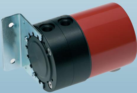
Les transmetteurs de pression différentielle de la série 652 conviennent pour le contrôle continu de niveau ou de débit de liquides (principalement dans le domaine du chauffage). Une construction spéciale et très robuste permet une grande surcharge unilatérale, qui en fonction des plages de mesure peut aller jusqu'à 20 bar.
