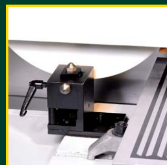
Diamantage de la meule en automatique avec compensation d'usure et de vitesse
